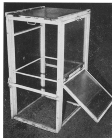
Abb. 18. Isolierkabine aus Frühbeetfenstern zusammengesetzt.
